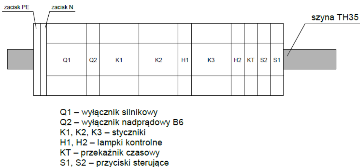
Rysunek 1. Rozmieszczenie elementów układu na szynie TH35
