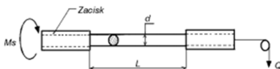
Schemat próby jednokierunkowego skręcania drutu
