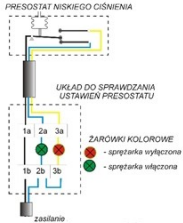
Rysunek 3. Schemat podłączenia układu do testowania presostatu.
