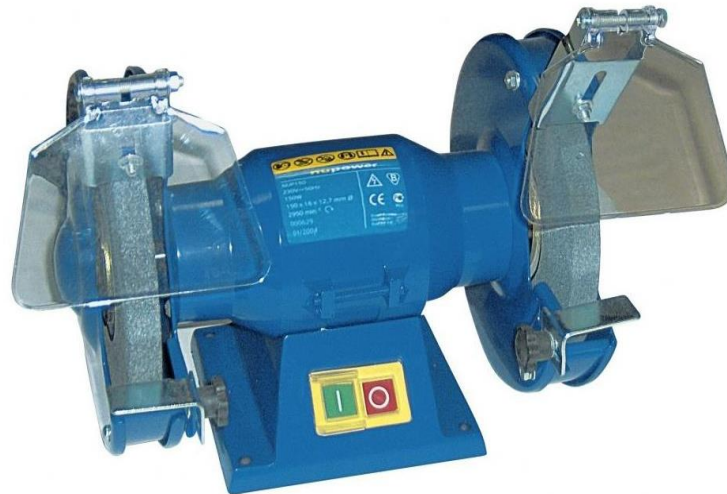
Rysunek 1. Stołowa szlifierka dwutarczowa (przykład)
